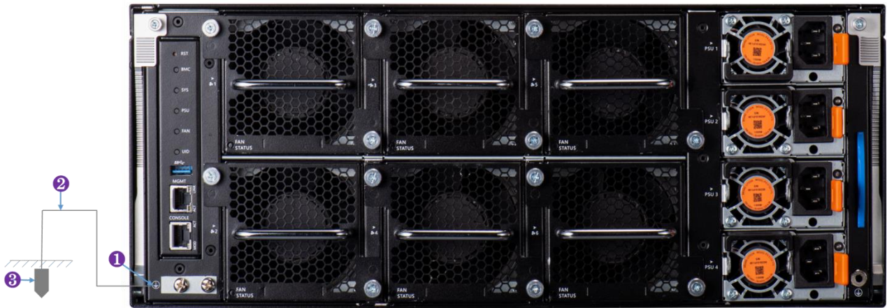
图 2-1 交换机接地线安装示意图
